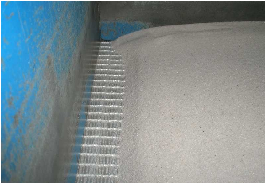
Figura 3.8 - Pormenor da zona junto à parede na parte de trás da caixa de corte no final do ensaio nº8.
