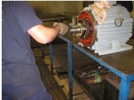
Figura 3.53. Montagem de rolamento (3)
