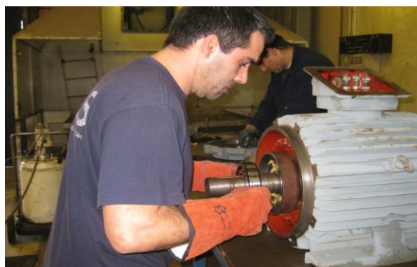
Figura 3.51. Montagem de rolamento (1)
