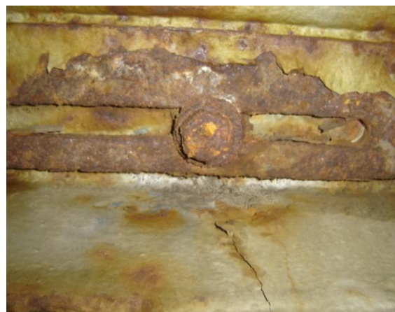
Figura 3.58. Corrosão no chassis
