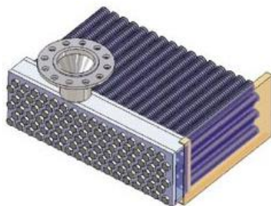
Figura 5.10. Forma da estrutura do permutador
