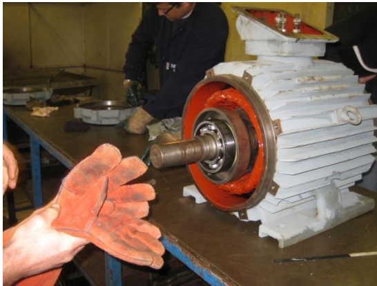
Figura 3.52. Montagem de rolamento (2)
