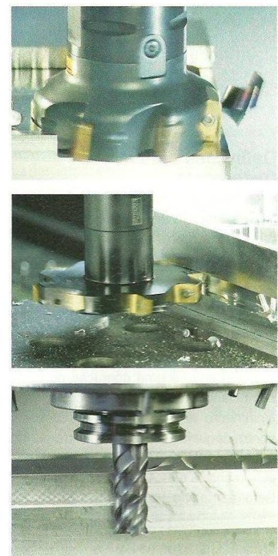
Figura 82 – Exemplos de fresas de pastilha ou inteiriças. Fonte: Sandvik
