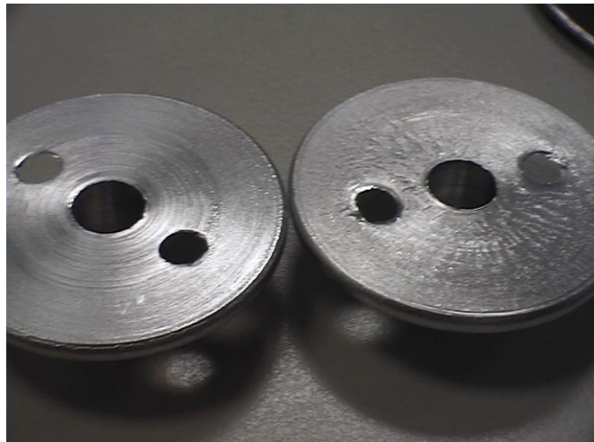
Figura 146 – Aspecto da face de sangramento das peças no ensaio.
