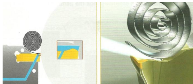
Figura 145 – Fluido com penetração ferramenta/peça. Fonte: Iscar Tools
