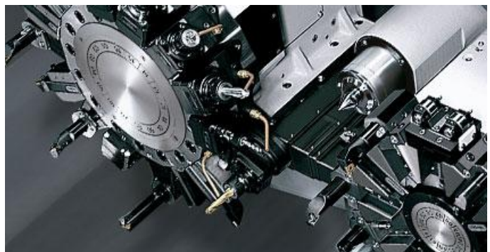
Figura 3 – Pormenor da torreta torno CNC. Fonte: Mazak Corporation
