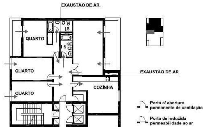
Figura 2.68: Esquema de uma solução de ventilação conjunta. Estão assinaladas as zonas de admissão, passagem e evacuação de ar [62].
