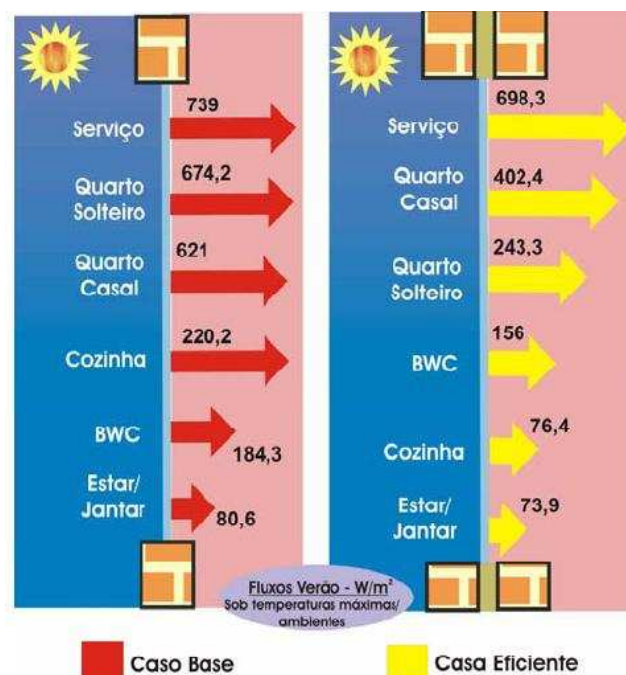
Figura 4.52: Fluxo de calor através de elementos envidraçados para diferentes ambientes interiores, no modelo 10 e no caso base. Os valores apresentados são para a situação de Verão e encontram-se expressos em W/m^2 [85].
