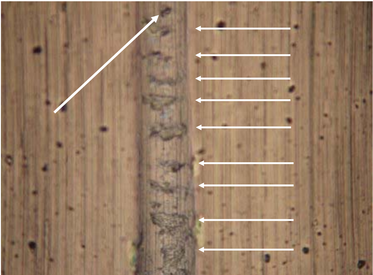
Figura 3.22 Primeira falha coesiva (seta superior), registada para uma carga normal de 15N e falhas subsequentes (direcção longitudinal)
