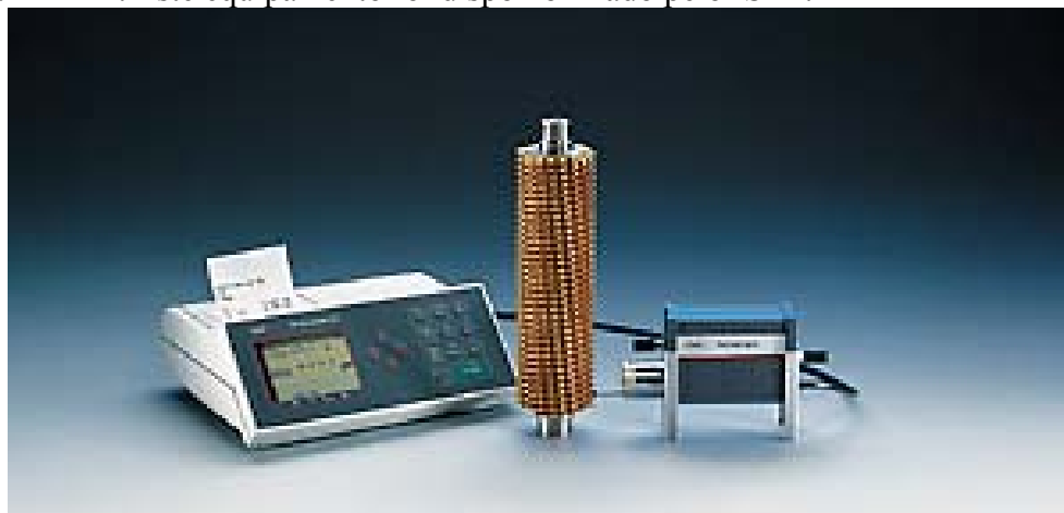
Figura 3.4 Aspecto geral do rugosímetro portátil MAHR, modelo PERTHOMETERT M2
