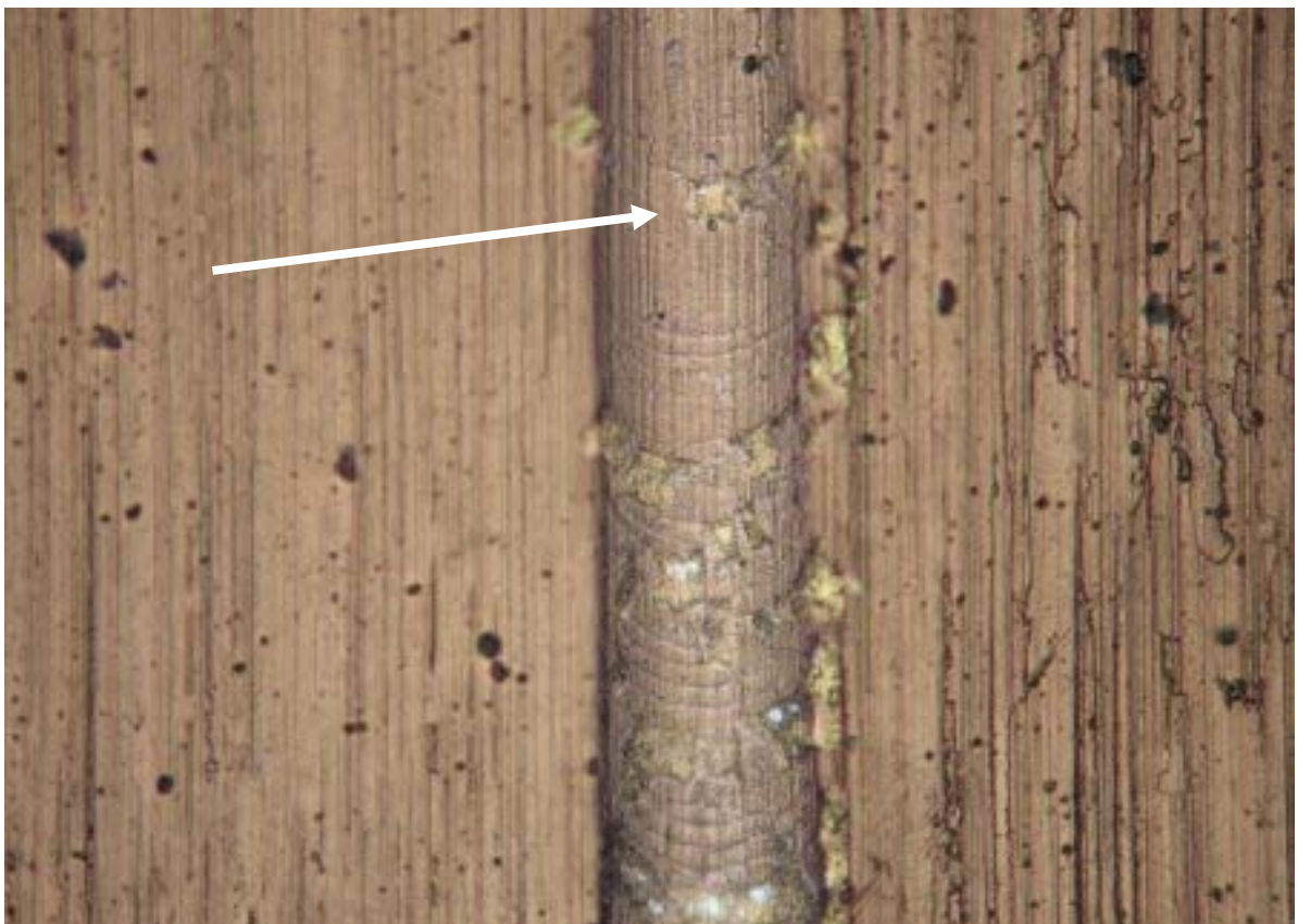
Figura 3.23 Primeira falha adesiva, aos 26N de carga normal (direcção longitudinal)
