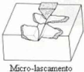
Figura 2.21 Representação esquemática do micro-mecanismo de abrasão: micro-lascamento [21]
