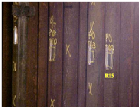
Figura 8 – Localização da zona onde foi recolhida a réplica (R 15) no feixe tubular.
