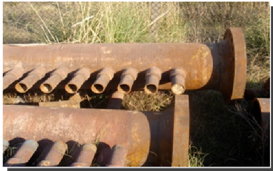
Figura 20 - Colectores da fornalha H - 3301
