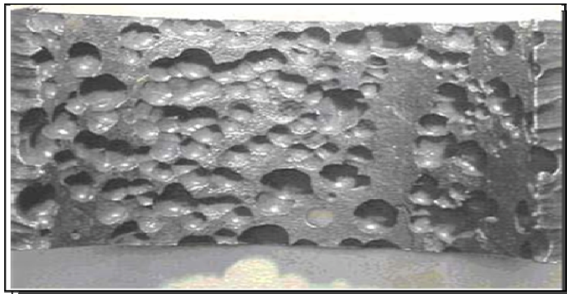
Figura 19 - Fenómeno de metal dusting num tubo de aço inoxidável [14]
