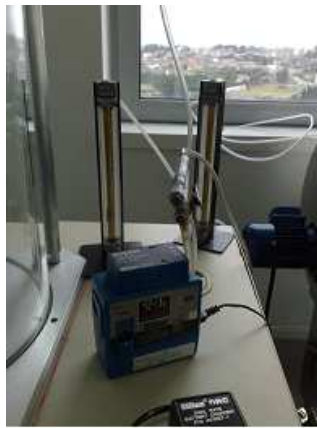
Figura 10 - Bomba acoplada ao tubo de Tenax
