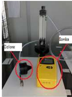
Figura 5 - medição do caudal de ar na cabeça de amostragem
