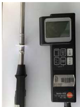
Figura 7 - Medição da temperatura e humidade
