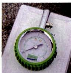
Figura 2 – Manómetro Regulador de Pressão.
