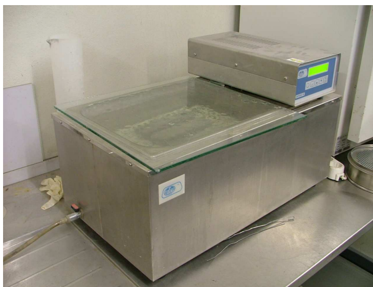
Figura 30 – Conservação dos provetes em água a 38 \pm 2^\circ\text{C} .
