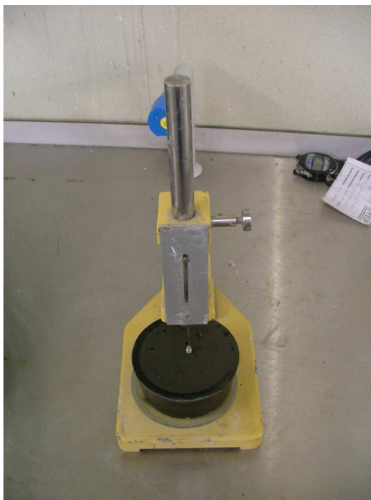
Figura 32 – Determinação do tempo de fim de presa da pasta com RHA.
