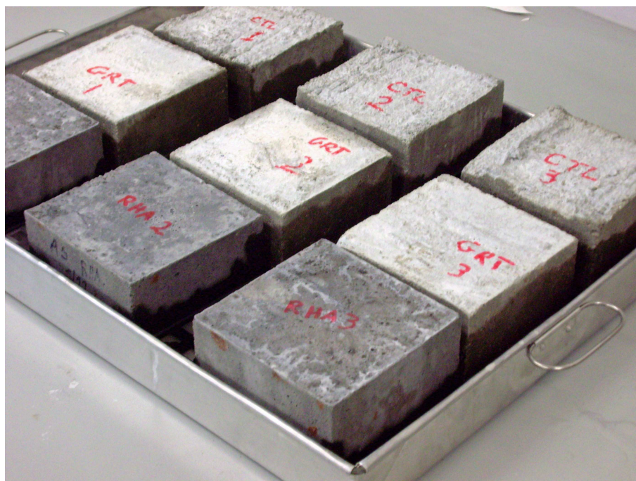
Figura 38 – Ensaio de absorção de água por capilaridade.
