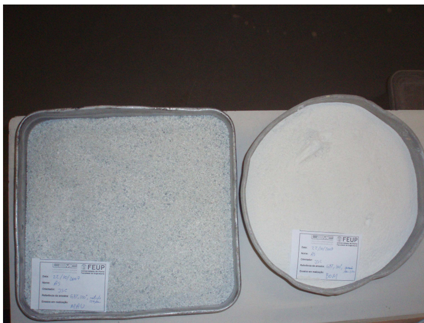
Figura 26 – Material retido no peneiro 250 \mu m (à esquerda, não utilizado) e restante material (à direita, utilizado nos ensaios).
