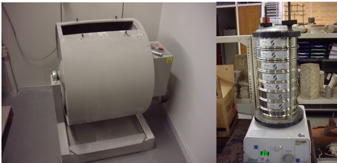
Figura 25 – Máquina utilizada na moagem dos grits (esquerda) e subsequente peneiração (direita).
