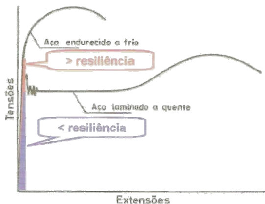
Figura 3.5 – Comparação da resiliência em aços com diferentes graus de ductilidade (Coutinho, 2005).
