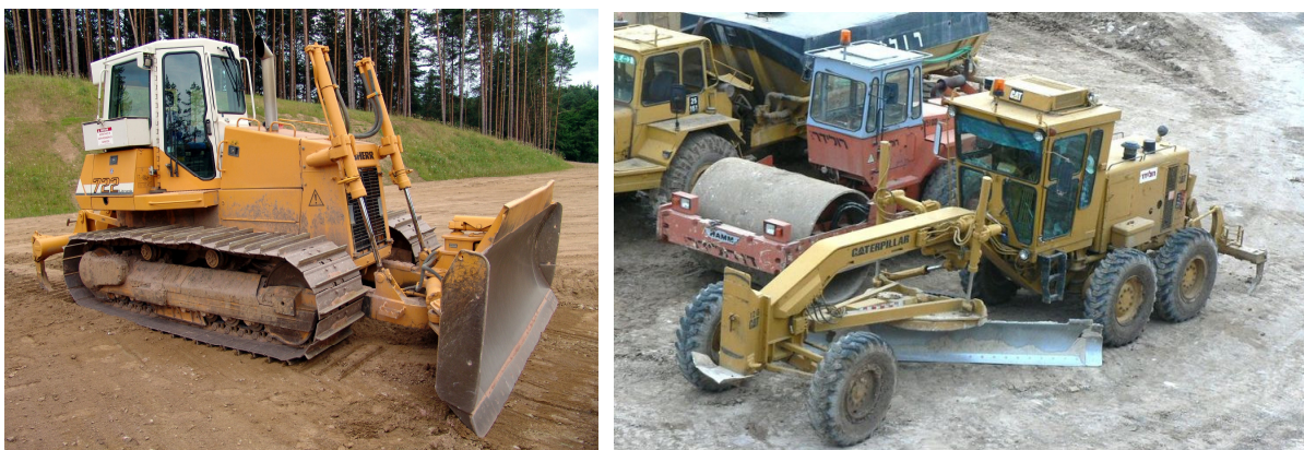
Fig.15 (esq.) e 16 (dir.) – Equipamento de construção civil: Bull Dozer (lado esquerdo) e Motoniveladora (lado direito). [25]
