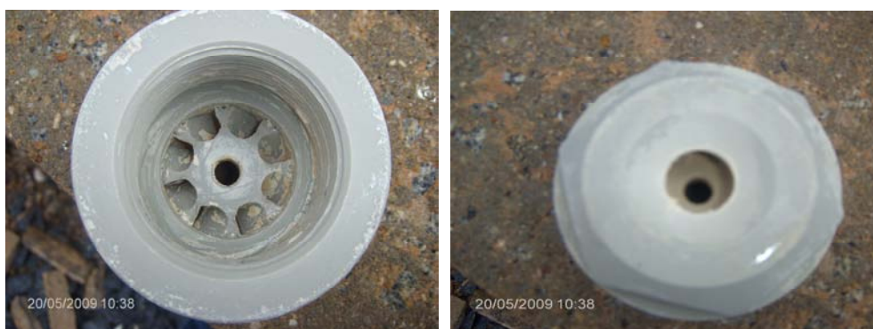
Figura 4.8: Chuveiro, topo (esquerda) e base (direita) após a limpeza.
