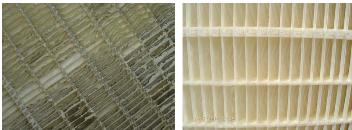
Figura 4.4: Separador de gotas antes (esquerda) e após (direita) limpeza.
