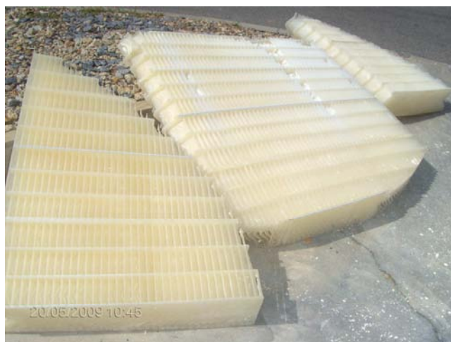
Figura 4.5: Separador de gotas desagregado.
