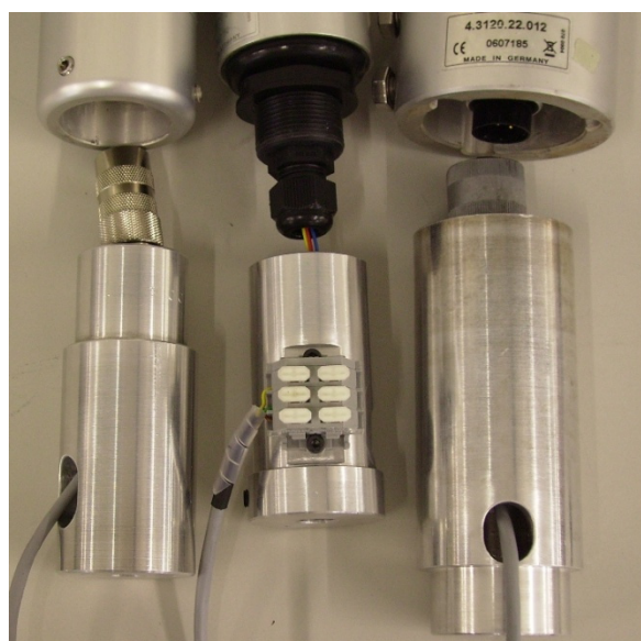
Figura 4.6 – Casquilhos dos vários cata-ventos com os cabos de ligação no seu interior (na esquerda modelo “First Class”, no centro modelo “Compact”, na direita modelo “Classic”)
