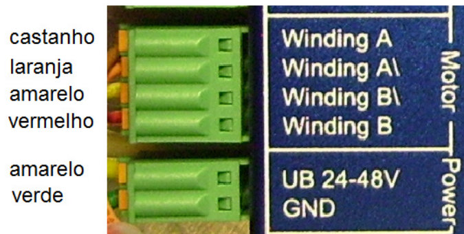
Figura D.1 – Esquema de ligação dos fios do motor e da alimentação do drive
