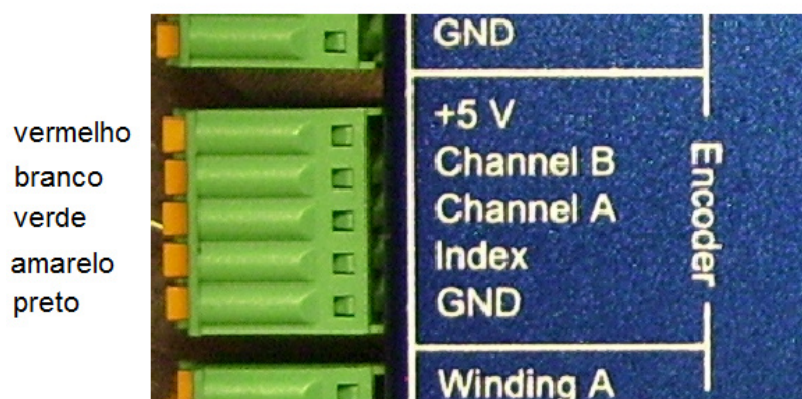
Figura D.2 - Esquema de ligação dos fios do encoder
