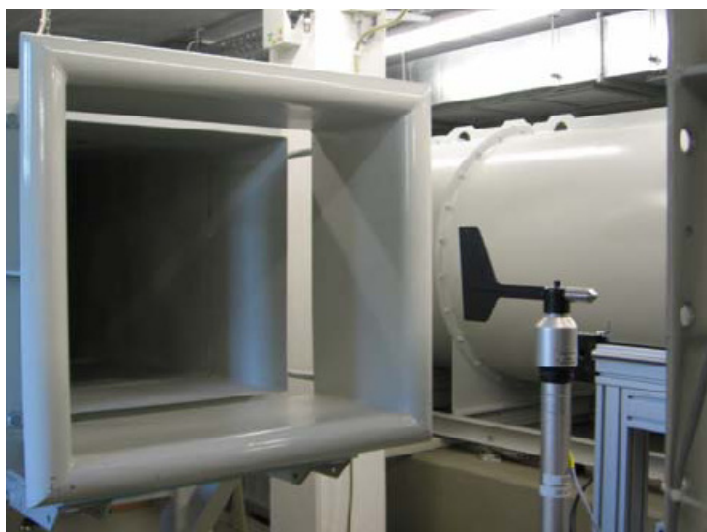
Figura 2.10 – Calibração do cata-vento modelo “Compact” da “THIES” no túnel de vento (Fonte: Certificado de calibração “Deutsche WindGuard Wind Tunnel Services, 03/2010, 10/1741 DKD-K-36801”)
