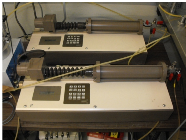
Fig 20 – Dois GDS com 200 ml de capacidade, utilizados nos ensaios triaxiais cíclicos
