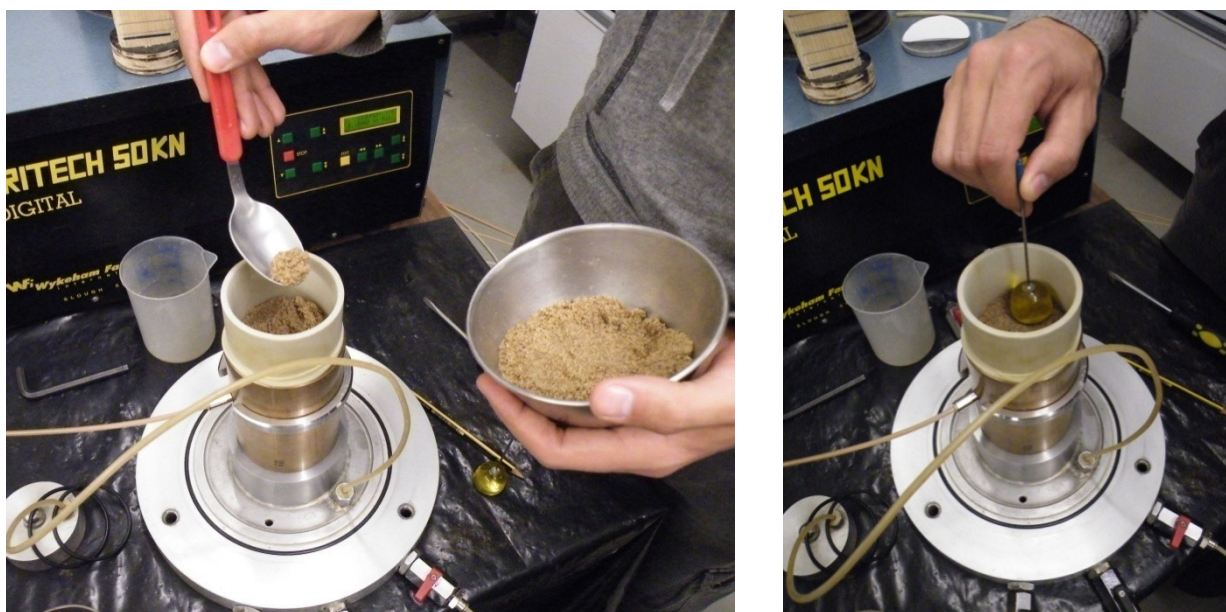
Fig 26 – Fotografias do processo de preparação das amostras por moist tamping (ponto 7 do procedimento descrito)
