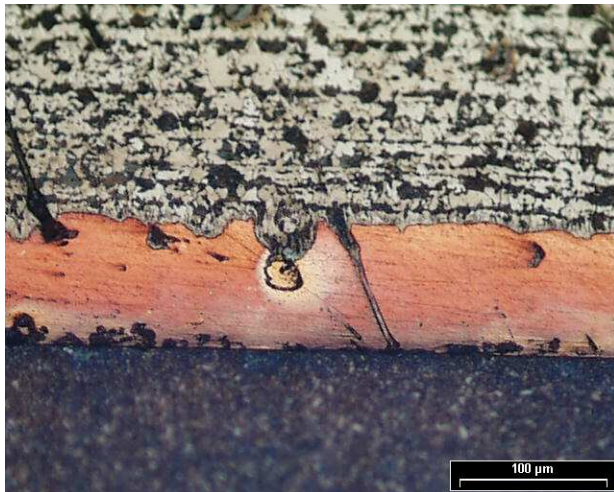
Figura 82: Microscopia óptica soldadura S6, ampliação 20x
