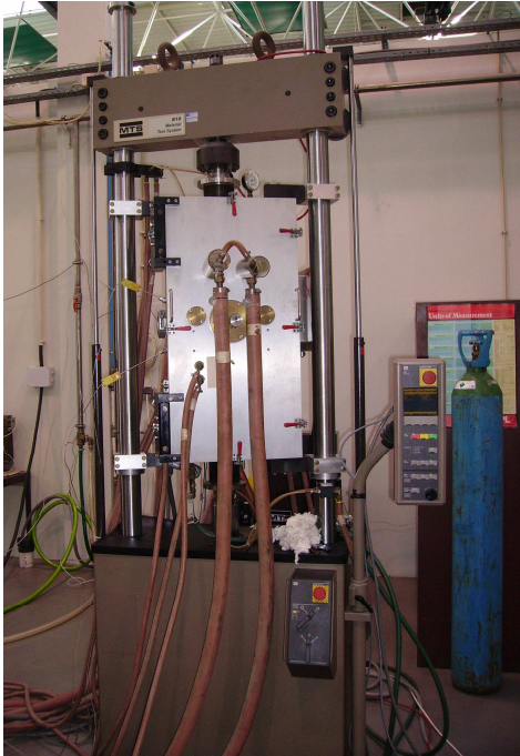
Figura 49: Pormenor da montagem da câmara de soldadura
