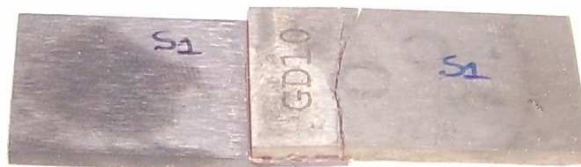
Figura 71: Soldadura S1 partida
