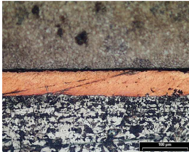
Figura 81: Microscopia óptica soldadura S4, ampliação 20x
