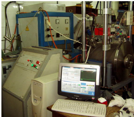
Figura 44: Vista geral do equipamento (forno, controlador de vácuo, controlador do sistema hidráulico de pressão)
