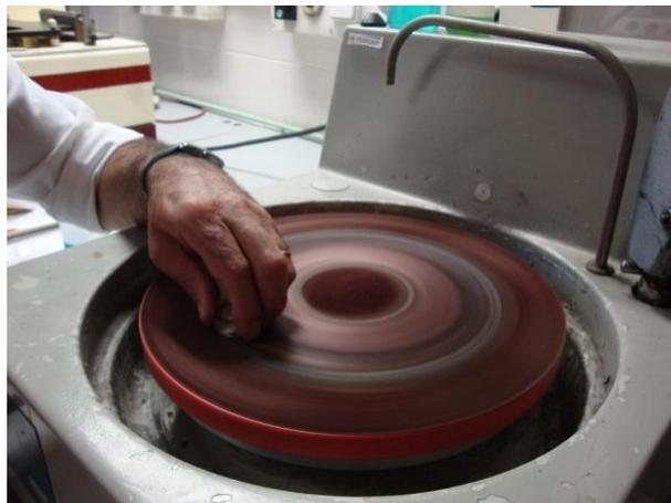
Fig.5.13 – Disco em rotação durante polimento segundo via manual – LNEG
