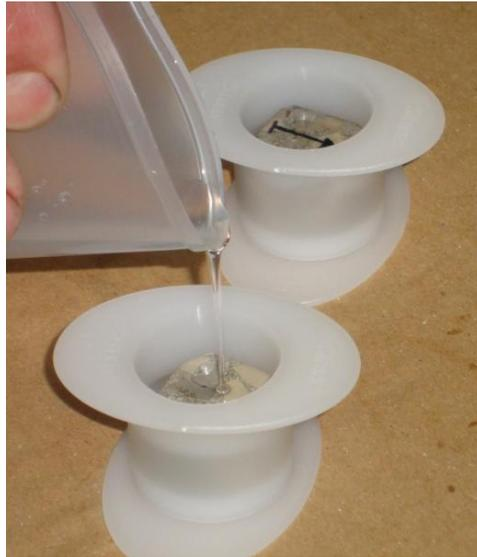
Fig.5.10 – Colocação da mistura sobre o espécime no molde – LNEG
