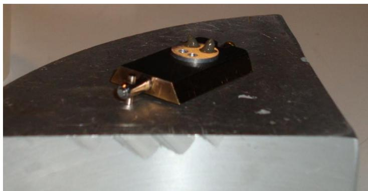
Fig.4.9 – Pasta no porta-amostras para visualização em Cryo-SEM
