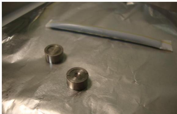
Fig.4.57 – Porta-amostras para ESEM juntamente com amostra dentro de tubo vedado sobre placa fria envolta em alumínio
