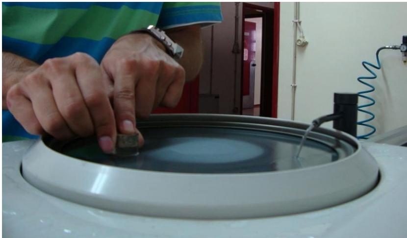
Fig.5.18 – Desbaste da amostra com pano de carboneto de silício e auxílio de água – CEMUP
