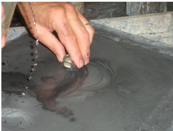
Fig.5.11 – Processo de desbaste com pó de carboneto de silício #1000 – LNEG
