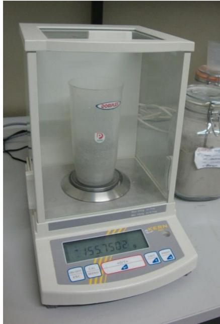
Fig.4.5 – Balança utilizada na pesagem dos materiais
