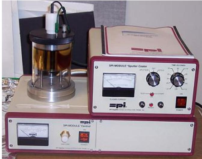
Fig.4.13 – Equipamento utilizado para revestimento de amostras SEM [1]
