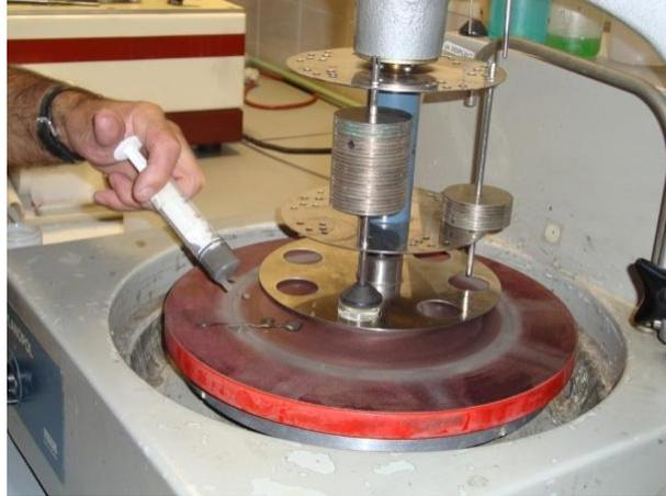
Fig.5.12 – Disco com equipamento para polimento segundo uma via mecânica – LNEG
