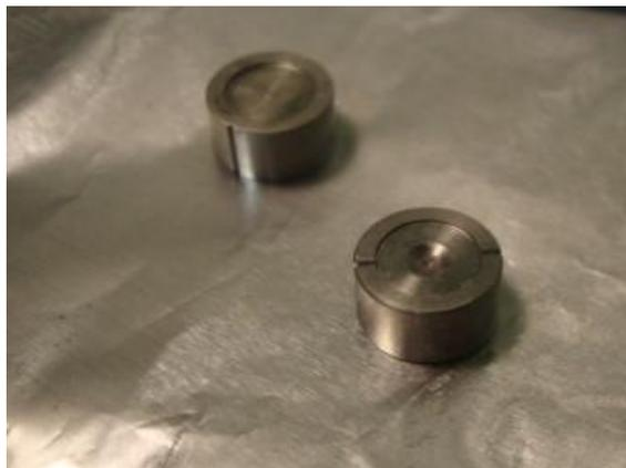
Fig.4.11 – Exemplos de porta-amostras utilizados em ESEM
