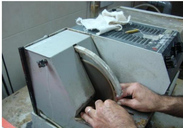
Fig.5.9 – Serra para corte das amostras de betão utilizada no LNEG.
