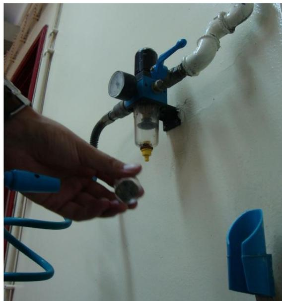
Fig.5.20 – Secagem do espécime com ar comprimido – CEMUP
