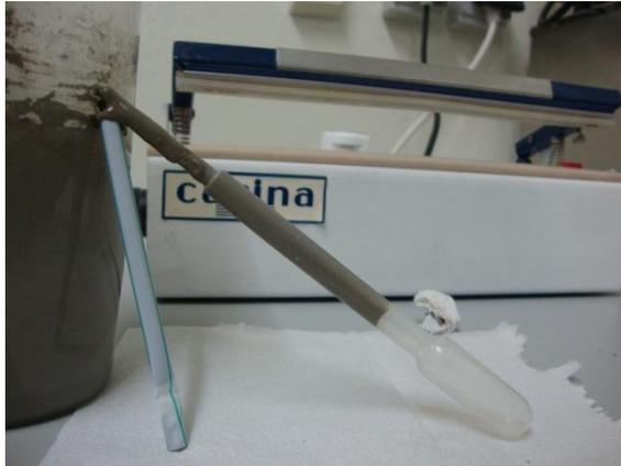
Fig.4.10 – Pipeta e tubo plástico onde a pasta é inserida após mistura
