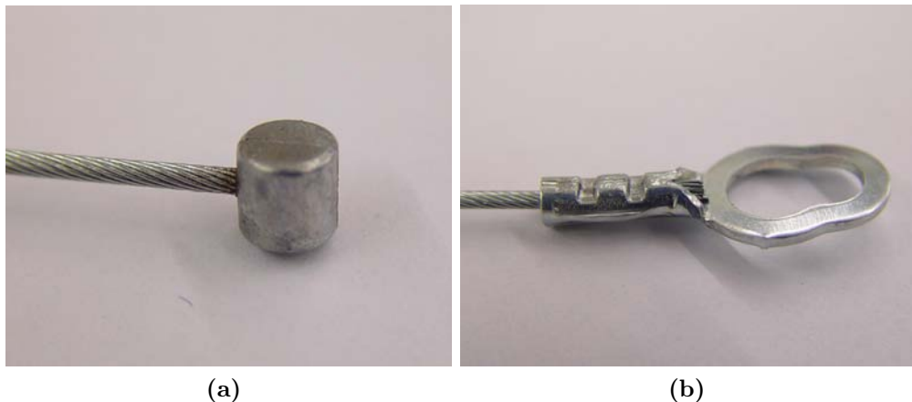
Figura 3.5.: Terminais aplicados às cordas de aço dos cabos utilizados: a) Terminal de cabo Zamak; b) Terminal de cabo olhal.
