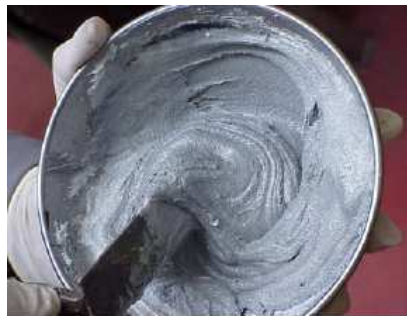
Fig.6. 22 – Aspecto de uma resina epóxida com consistência de massa
