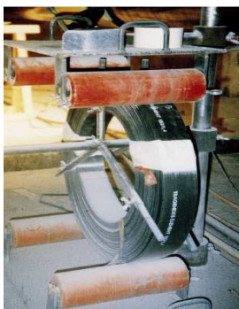
Fig. 4.11 – Laminado de F.R.P. pronto a ser cortado
