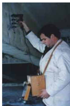
Fig. 3.13 – Medição da resistividade numa viga [6]
