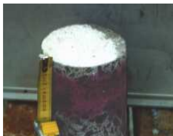
Fig. 3.9 – Medição da profundidade de carbonatação [6]
