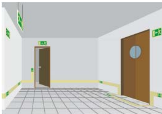
Fig.3.13 – Correcta sinalização das vias de evacuação, saídas e saídas de emergência [25].
