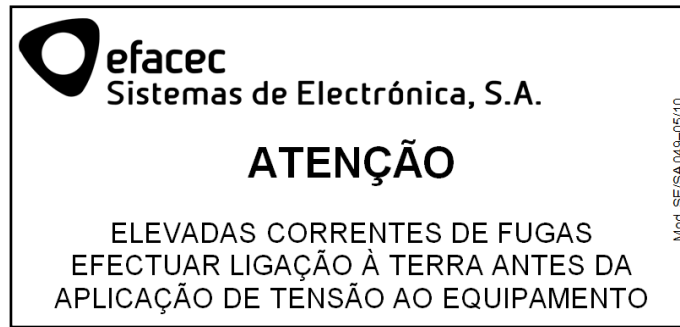
Figura 4.27 - Etiqueta para equipamentos com elevadas correntes de fugas.
