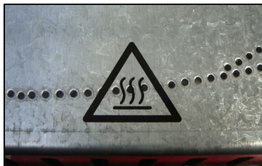
Figura 4.24 - Etiqueta de aviso de superfície quente - Tampa do chassis.
