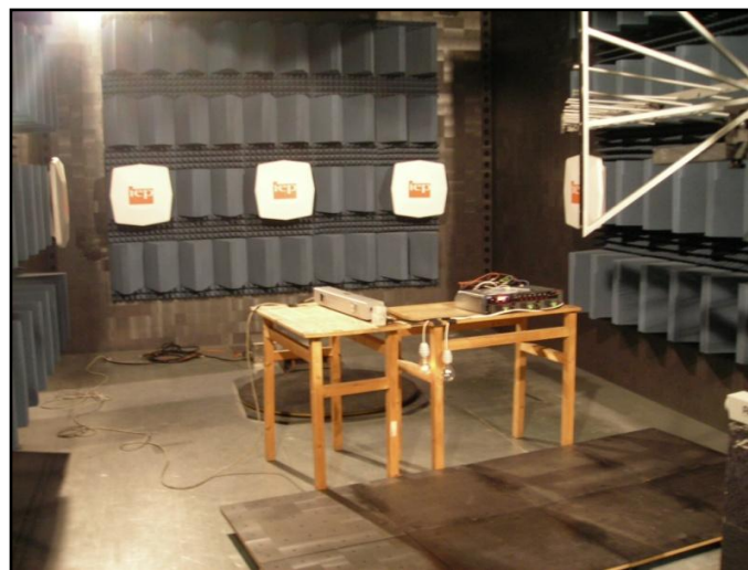
Figura 6.20 - Montagem IEP para o Ensaio de Imunidade Radiada - Campos Electromagnéticos. EFAPOWER CIB S 48V/40A c/microPSM Rack 19'' 2U.
