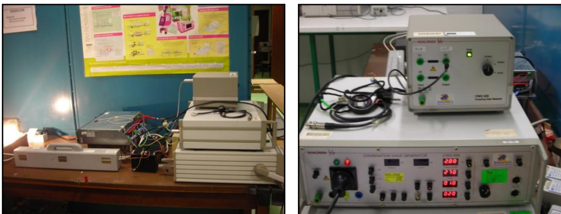
Figura 6.29 - Montagem IEP para o Ensaio de Imunidade Conduzida - Onda Choque. EFAPOWER CIB S 48V / 40A c/microPSM Rack 19'' 2U.
