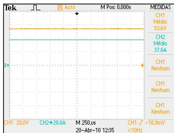
Figura 3.28 - Tensão e corrente de saída do EFAPOWER CIB S 48V/40A c/microPSM Rack 19'' 2U.
