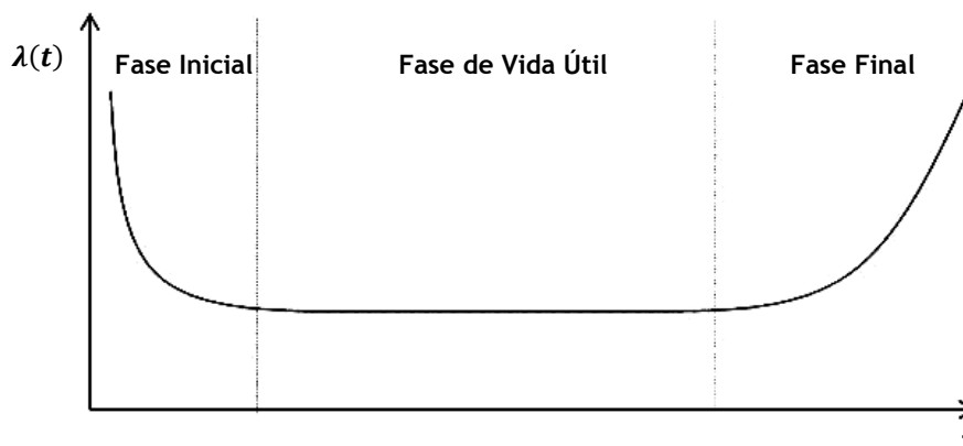
Figura 7.4 - Variação da Taxa de Falhas ou de Avarias durante a vida de um sistema/equipamento.
