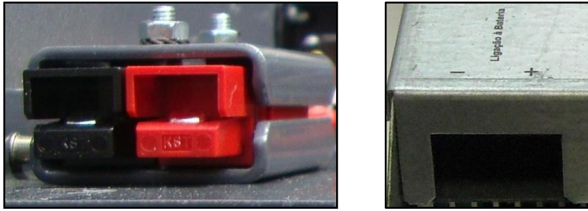
Figura 4.8 - Terminal de ligação das baterias e respectiva polaridade indicada na tampa superior do chassis do equipamento.
