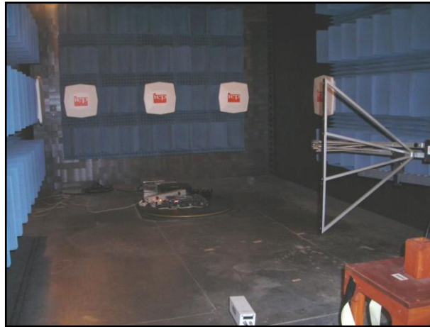
Figura 6.2 - Câmara semi-anecoica IEP, Ensaio de Emissão Radiada - Campos Electromagnéticos. EFAPOWER CIB S 48V/40A c/microPSM Rack 19'' 2U.
