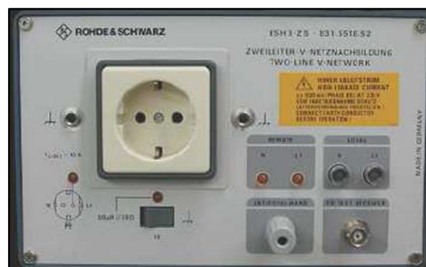
Figura 6.11 - Exemplo de uma Rede de Estabilização de Impedância de Linha.
