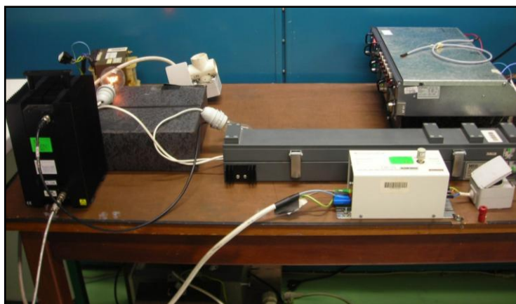
Figura 6.33 - Montagem IEP para o Ensaio de Imunidade Conduzida - Correntes de RF Injectadas. EFAPOWER CIB S 48V/40A c/microPSM Rack 19'' 2U.
