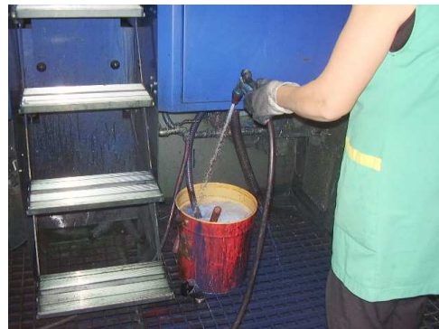
Figura 32 - Início da lavagem automática da unidade impressora
