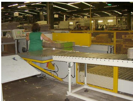
Figura 29 – Operador 3 a introduzir atados de caixas no paletizador
