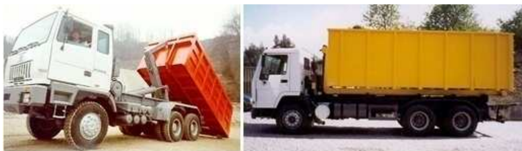
Figura 25 - Colocação da caixa em cima do chassis e camião com caixa de 25 m 3 (Sounete, 2009).
