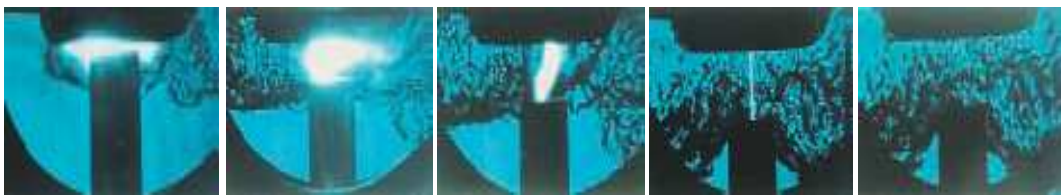
Figura 3.2: Representação por sequências da extinção do arco eléctrico em SF 6 [25]
