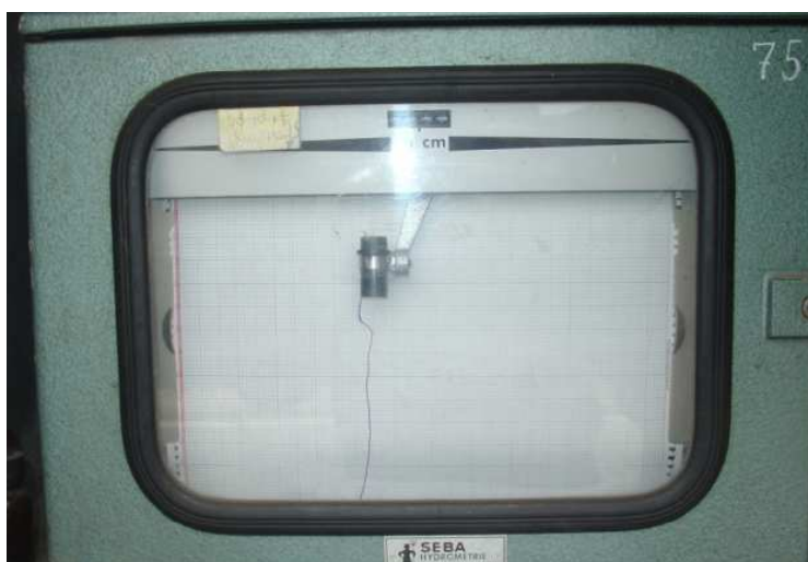
Figura 2.8 - Limnigrama da estação hidrométrica de Ponte Remondes, rio Sabor (fotografia tirada no dia 4 de Dezembro de 2009, durante uma campanha de medições de caudal)
