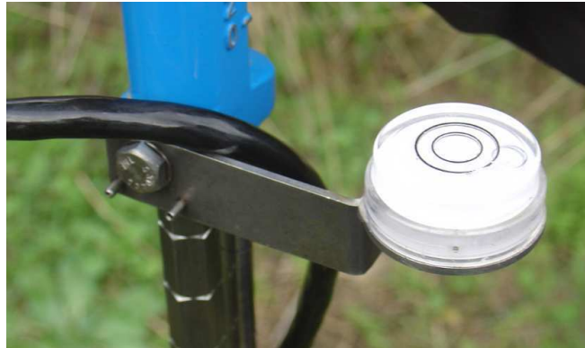
Figura 3.25 – Bolha que permite controlar a verticalidade da haste do Flow Tracker ADV (fotografia tirada no rio Azibo no dia 4 de Dezembro de 2009, durante uma campanha de medições de caudal)
