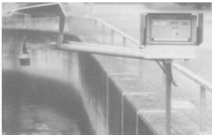
Figura 2.7 - Limnígrafo ultra-sónico (adaptado de W. Boiten 2000)
