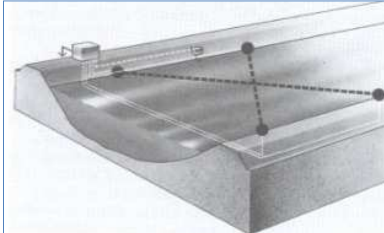
Figura 11 - Exemplo de Sistema de Medição Acústico (adaptado de Boiten, 2000)
