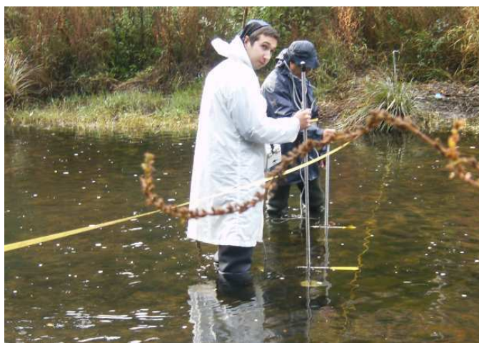
Figura 2.25 – Exemplo de uma medição a vau (fotografia foi tirada no rio Corgo, na estação hidrométrica de Ermida, no dia 12 de Novembro de 2009, durante uma campanha de medições de caudal)
