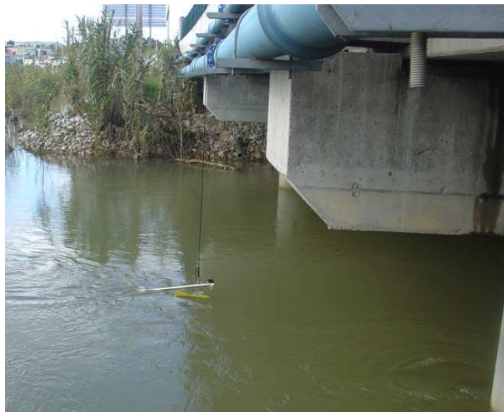
Figura 2.27 - Medição efectuada a partir de uma ponte (fotografia tirada no rio Almonda, na estação de Ponte Nova, no dia 15 de Janeiro de 2010, durante uma campanha de medições de caudal)
