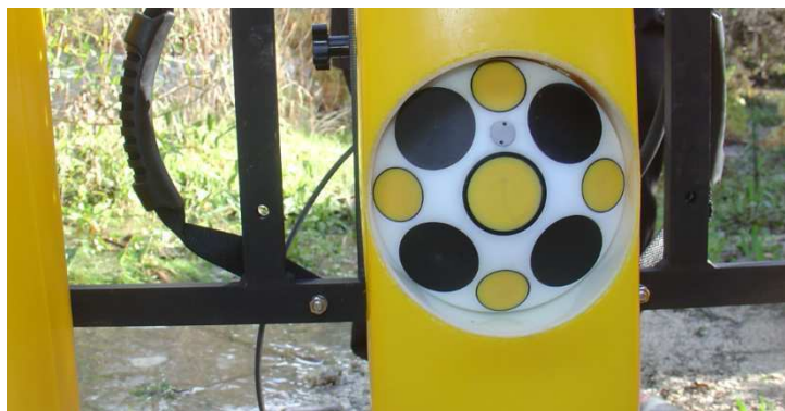
Figura 3.23 - Configuração de 9 feixes (River Surveyor M9)
