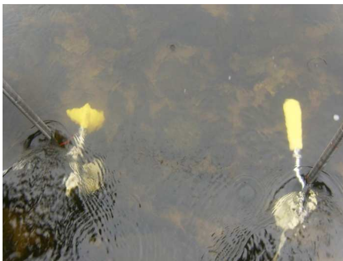
Figura 3.10 - Fotografia tirada no rio Corgo, na estação de Ermida, no dia 12 de Novembro de 2009, durante uma campanha de medições de caudal (molinete hidráulico à esquerda e sensor electromagnético à direita)
