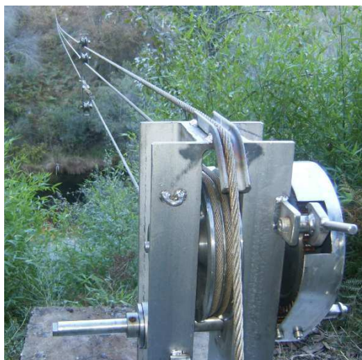
Figura 2.30 – Teleférico (fotografia tirada no rio Paiva, na secção de Castro Daire, no dia 16 de Outubro de 2009 durante uma campanha de medições de caudal)
