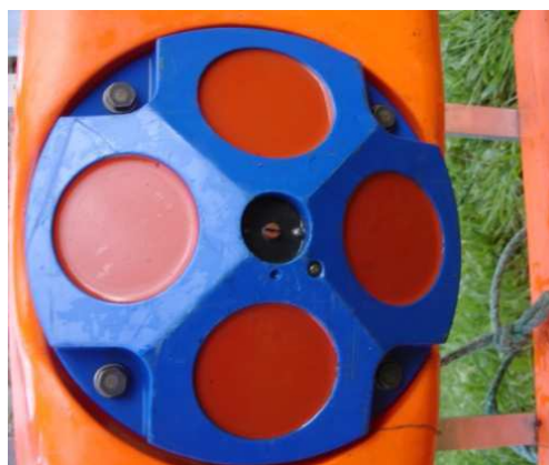
Figura 3.22 - Configuração de 4 feixes (Rio Grande ADCP)
