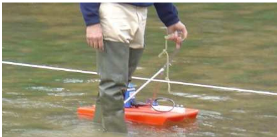
Figura 2.33 - Fotografia tirada no rio Azibo, a jusante da estação de Azibo, no dia 4 de Dezembro de 2009, durante uma campanha de medições de caudal, em parceria com a EDP, INAG e QUALITAS (o aparelho que efectua medições é o Stream Pro)
