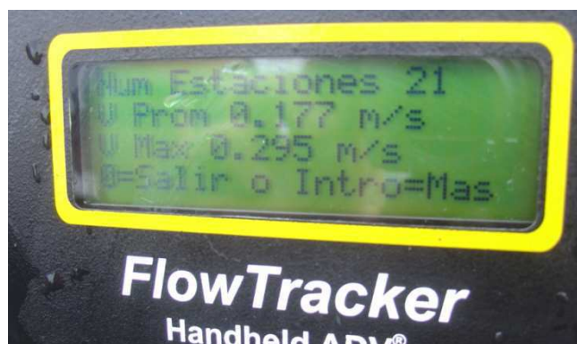
Figura 3.27 – Indicador do Flow Tracker ADV a mostrar velocidades obtidas na medição e o número de verticais medidas (fotografia tirada no rio Azibo no dia 4 de Dezembro de 2009)
