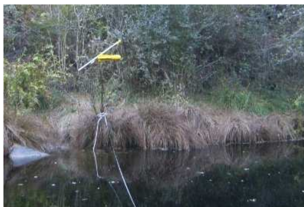
Figura 2.29 - Fotografia do aparelho suspenso por cabo a partir de um teleférico, tirada no rio Paiva, na estação de Castro Daire, no dia 16 de Outubro de 2009, durante uma campanha de medições de caudal (molinete C 31 suspenso por cabo com peso)
