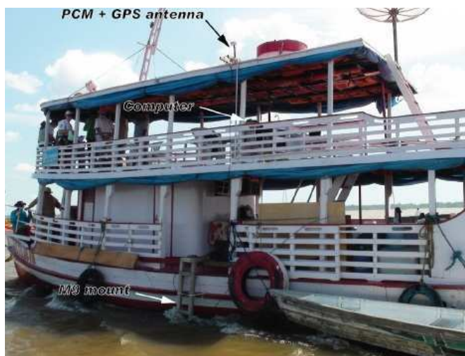
Figura 2.34 - River Surveyor M9 acoplado a um barco (adaptado de notícias Sontek 2009, Amazónia)
