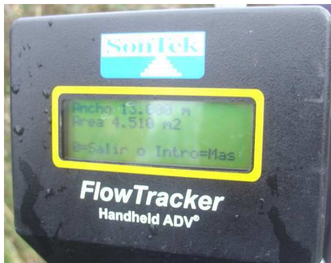
Figura 3.26 – Aparelho indicador do Flow Tracker ADV; neste caso indica a área e a largura da secção medida [fotografia tirada no rio Azibo no dia 4 de Dezembro de 2009, durante uma campanha de medições de caudal]
