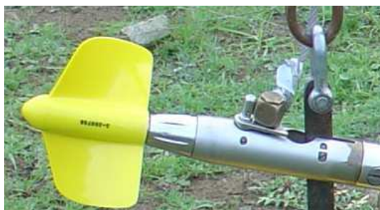
Figura 3.1 - Exemplo de molinete de hélice – de eixo horizontal (fotografia tirada ao Molinete C 31, utilizado na campanha de medições de caudal)
