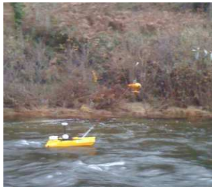
Figura 2.31 - Foto tirada no rio Paiva, na estação de Castro Daire, no dia 3 de Dezembro de 2009, durante uma campanha de medições de caudal (River Surveyor M9, apoiado num trimaran, suspenso por cabo em teleférico e peso)
