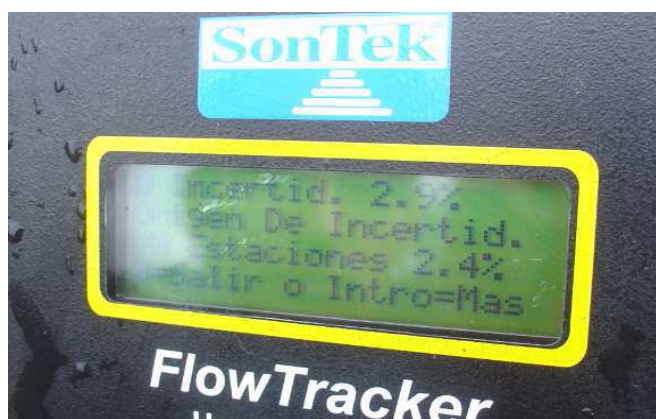
Figura 3.29 – Indicador do Flow Tracker ADV a mostrar incerteza obtida na medição efectuada (fotografia tirada no rio Azibo no dia 4 de Dezembro de 2009, durante uma campanha de medições de caudal)
