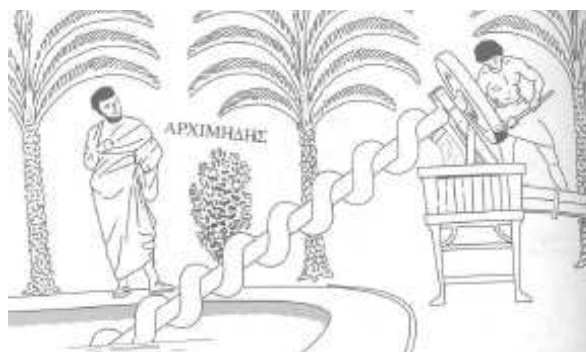
Figura 13 - Bomba do tipo Arquimedes na sua forma primitiva (adaptado de W. Boiten 2000)
