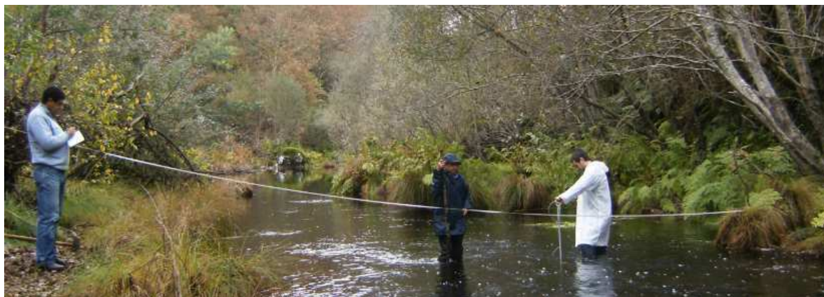
Figura 2.14 - Exemplo da medição da largura de uma secção com recurso a uma fita graduada e da flecha adquirida pela mesma; exemplo de uma vertical a ser sondada com recurso a haste (fotografia tirada durante uma campanha de medições de caudal no dia 4 de Novembro de 2009)
