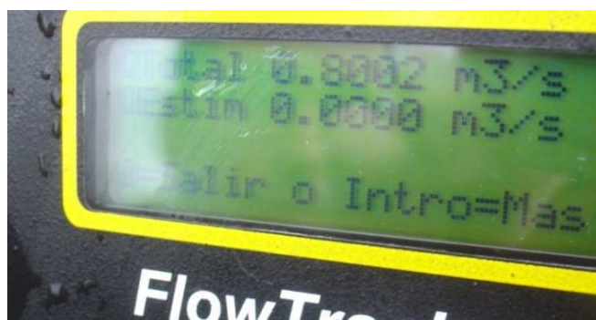
Figura 3.28 – Aparelho indicador do Flow Tracker ADV a mostrar caudal obtido durante a medição (fotografia tirada no rio Azibo no dia 4 de Dezembro de 2009, durante uma campanha de medições de caudal)
