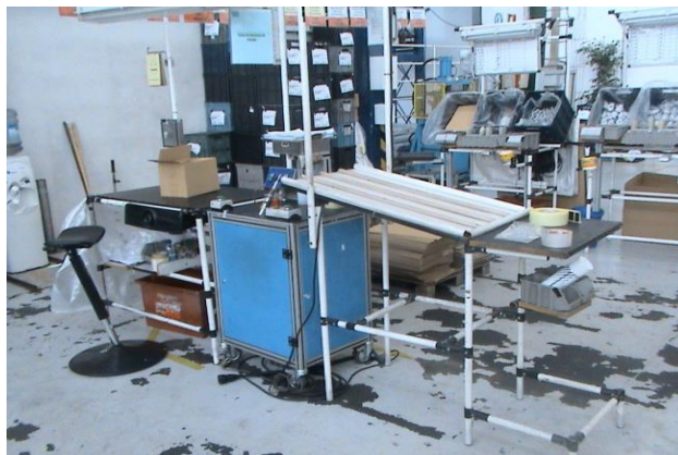
Figura 59 - Estação de re-trabalhos.
