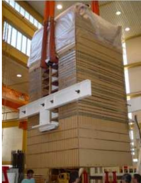
Figura 7 – Fase de um Transformador SHELL
