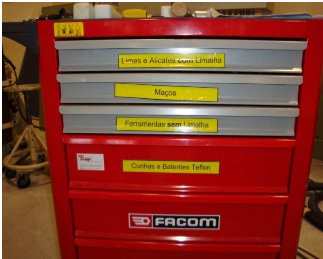
Figura 38 - Organização e Marcação de Carro de Ferramentas de Apoio à Bobinagem
