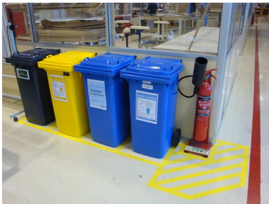
Figura 35 - Marcação de Contentores de Resíduos Vários e Extintores
