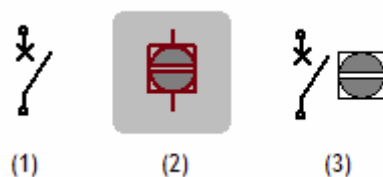
Figura 4 - Exemplo dos três modos de visualização de um disjuntor: (1) 'Circuito', (2) 'Consola' e (3) 'Circuito + Consola'.
