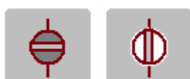
Figura 26 - Exemplo de um botão de um seccionador: à esquerda com estado concordante e à esquerda discordante.
