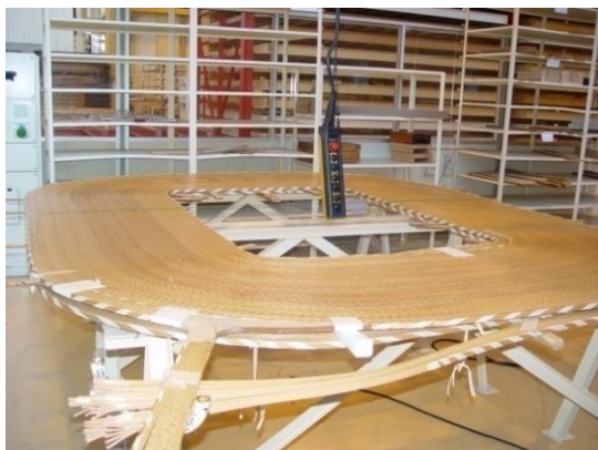
Figura 5 – Galete de um transformador SHELL.
