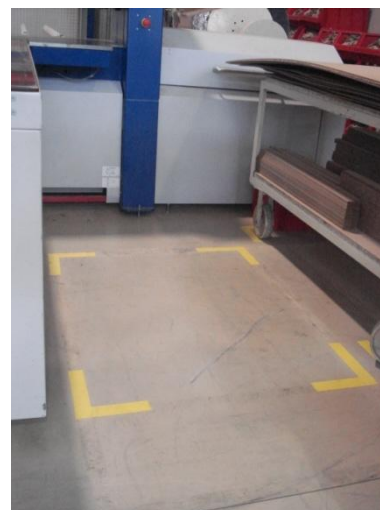
Figura 72 – Marcação de carro de transporte de calços.
