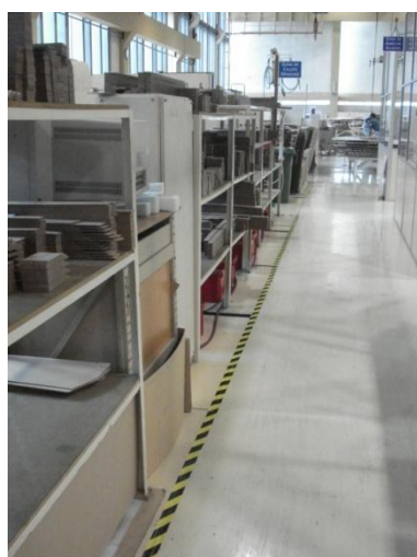
Figura 76 – Marcação do local de acesso posterior às prateleiras de calços.
