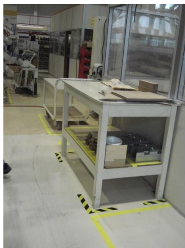
Figura 71 – Marcação de mesa e local de ferramentas na mesa de traçagem do bridge .
