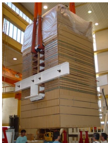
Figura 3 – Fase de um transformador SHELL.
