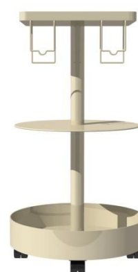
Figura 51 – Carro de apoio à soldadura (vista frontal).
