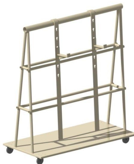
Figura 49 – Carro de transporte de rodela concebido (vista isométrica).
