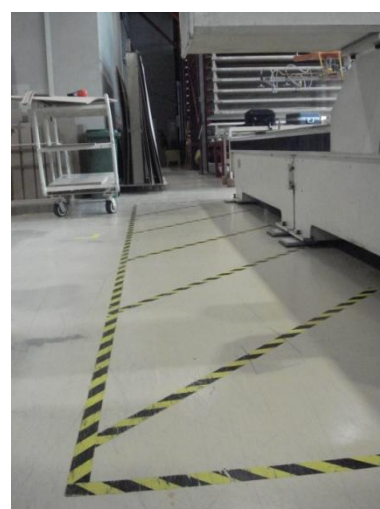
Figura 77 – Delimitação da zona de movimentação do braço mecânico da CNC.
