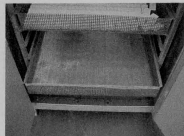
Figura 46 – Prateleira da mufla forrada com rede inoxidável
