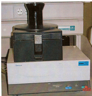
Figura 2 – Fotografia do Moinho Retsch – ZM 100.
