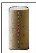
Figura 3.2. Esquema de corte da rolha para quantificação do d_5 -TCA no interior.
