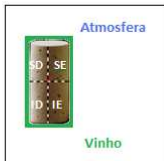
Figura 3.3. Esquema do modo de seccionamento da rolha de cortiça natural em quatro partes
