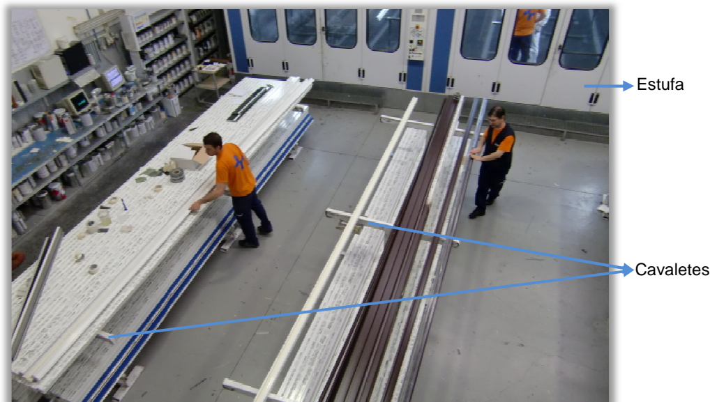
Figura 15 – Fase 1: Área destinada à preparação dos perfis.
