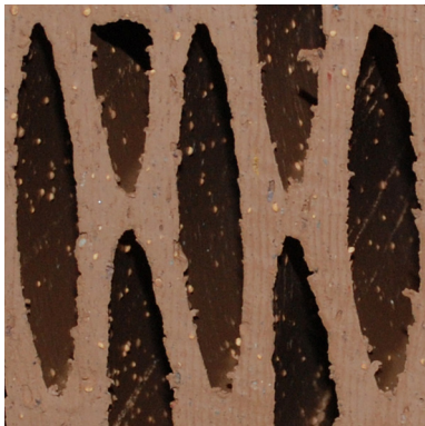
Figura 58: Pasta cerâmica crua com poliestireno (EPS), bloco “ThermoPlan MZ8”, betão aligeirado com argila expandida
