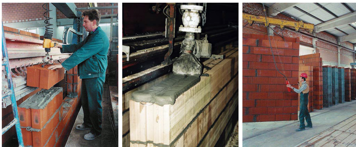
Figura 66: Produção de painéis prefabricados de alvenaria (fontes: Franken Ziegel [76], Ziegel Elementbau [98])
