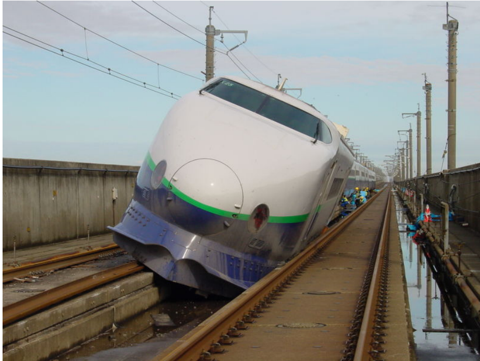
Figura 2.5 - Descarrilamento de um comboio Shinkansen na sequência do sismo de 2004 no Japão ( http://www.wikipedia.com , 2007)
