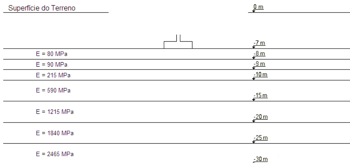
Fig.5.11 – Perfil geotécnico para estratificação do solo
