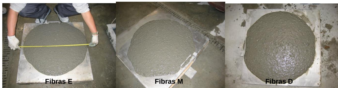
Fig. 5.13 Ensaio de espalhamento
