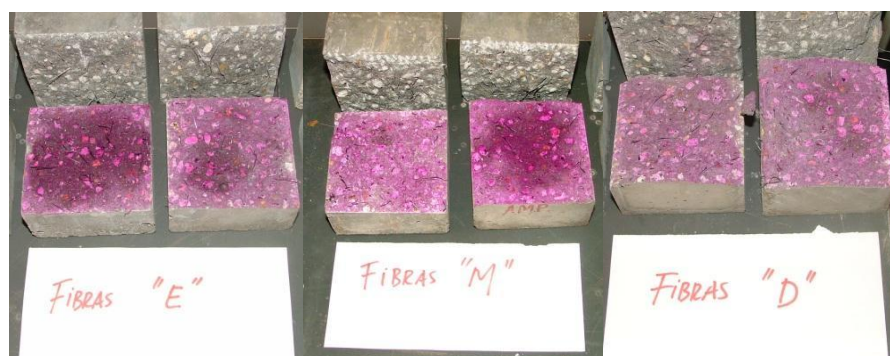
Fig. 5.24 Provetes após determinação da frente de carbonatação
