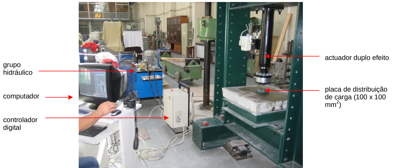
Fig. 5.16 Equipamento utilizado na realização nos ensaios sobre placas quadradas.
