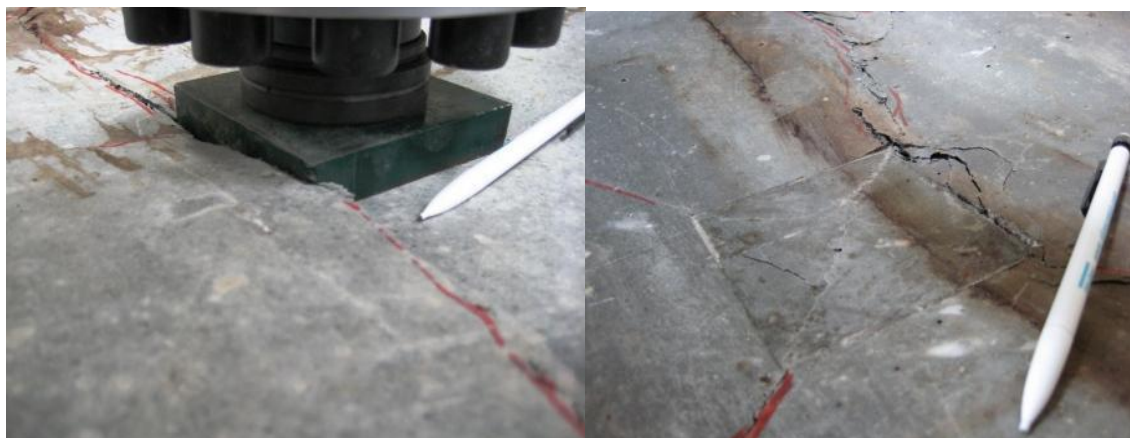
Fig. 5.21 Rotura por corte e punção da placa 112BC2 e 112BC1, respectivamente.
