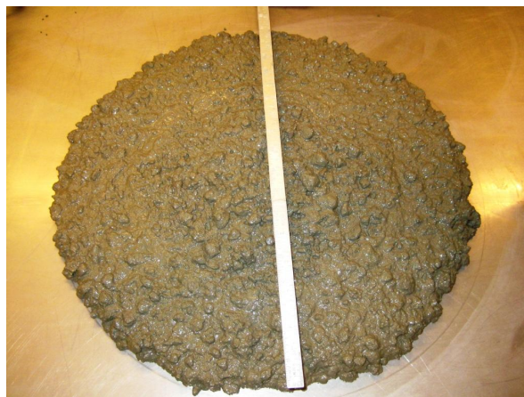
Fig. 5.5 Aspecto do betão B35
