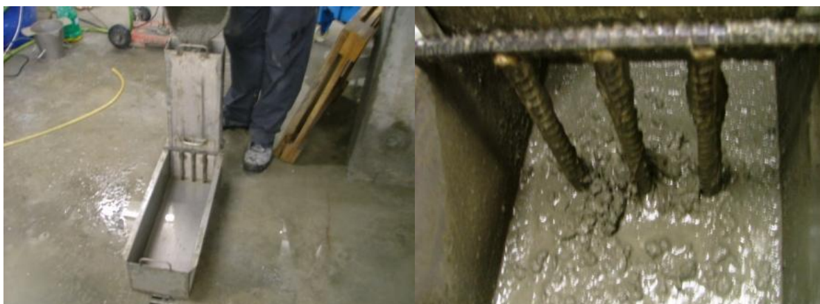
Fig. 5.14 Ensaio L-BOX; (a) caixa-L utilizada; (b) resistência ao bloqueio
