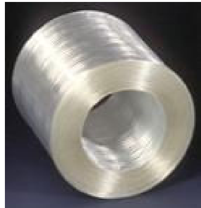
Fig. 2.9 - Fibra de vidro em rolos ( roving ) [11]
