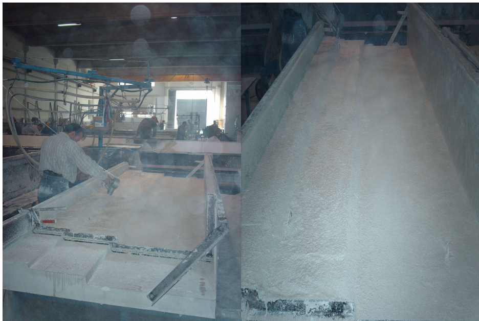
Fig. 3.8 - Produção de painel de GRC por projecção directa
