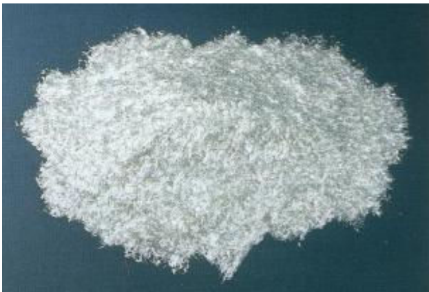
Fig. 2.8 - Fibra de vidro pré-cortada ( chopped ) [11]
