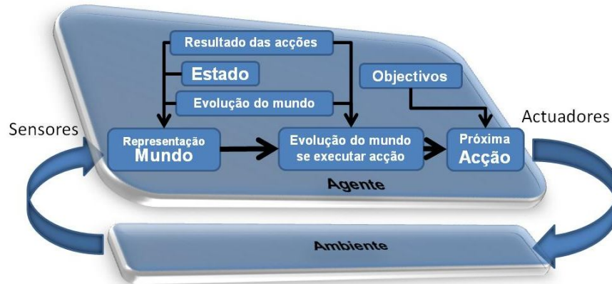
Figura 17: Diagrama esquemático de um agente gerido por objectivos
