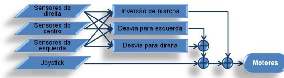
Figura 72: Arquitectura de subsunção utilizada no controlo de desvio de obstáculo
