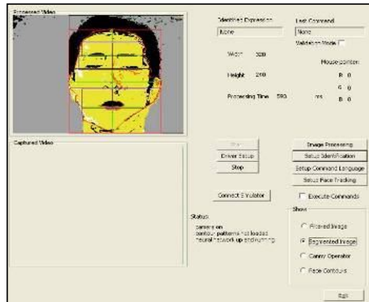
Figura 122: Interface do módulo de controlo por expressão facial
