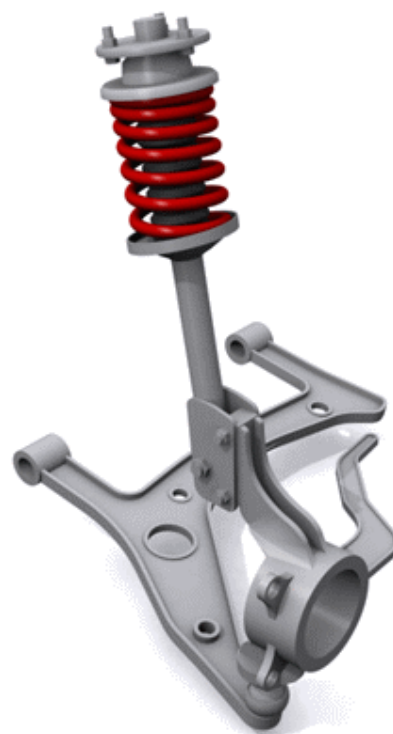
Figura 9 - Ilustração de uma suspensão do tipo MacPherson [3]
