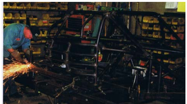
Figura 46 - Chassis completo tubular incluindo armadura de segurança de um automóvel do campeonato NASCAR [16]
