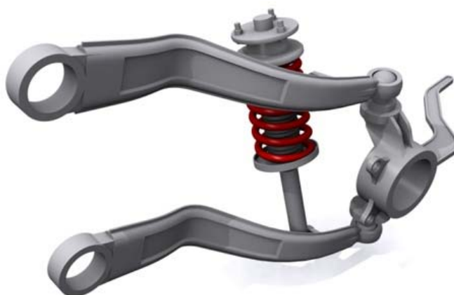
Figura 10 - Ilustração de uma suspensão do tipo "trailing arm" [3]
