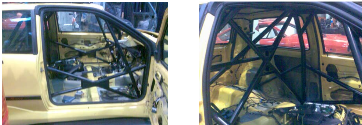
Figura 6 - Fotos da armadura de segurança após montagem
