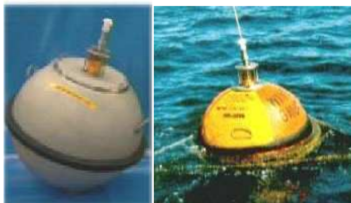
Figura 14 – Bóia ondógrafo direccional (origem IH).
