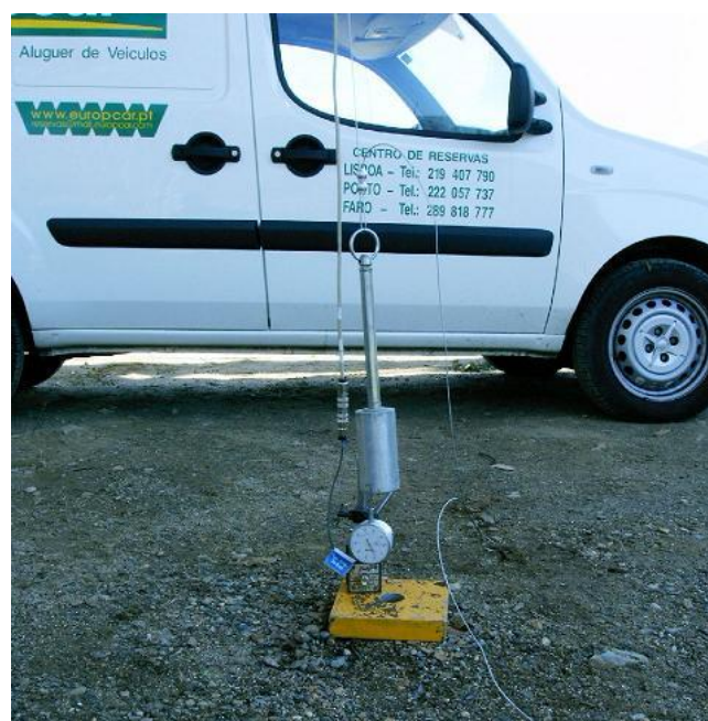
Fig. 4.47 - Ilustração do comparador eléctrico usado na primeira fase do ensaio de carga.
