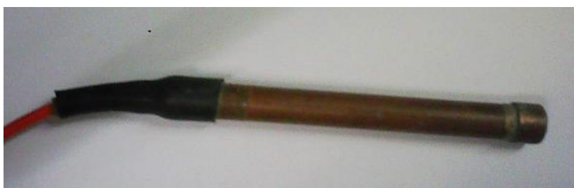
Fig. 2.16 - Encapsulamento do sensor de temperatura PT100.
