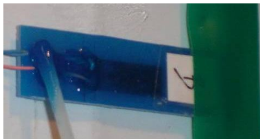
Fig. 2.6 – Aspecto do extensómetro eléctrico.
