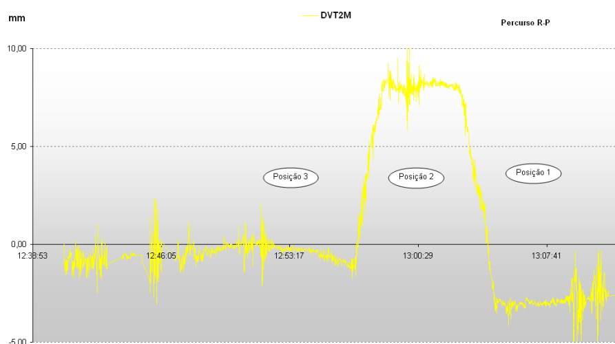
Fig. 4.95 – Deslocamentos verticais a meio-vão do 2º Tramo medidos do lado de montante.
