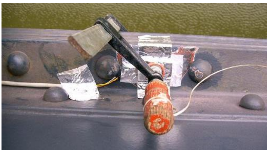
Fig. 2.9 – Aplicação de pressão mecânica durante a colagem do transdutor.
