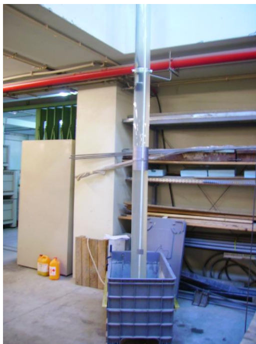
Fig. 3.22 – Representação do ensaio para medir o efeito da salinidade da água.
