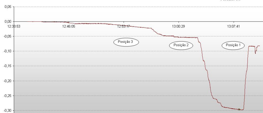
Fig. 4.101 – Abertura da junta de dilatação localizada no 1º tramo sobre o pilar P1
