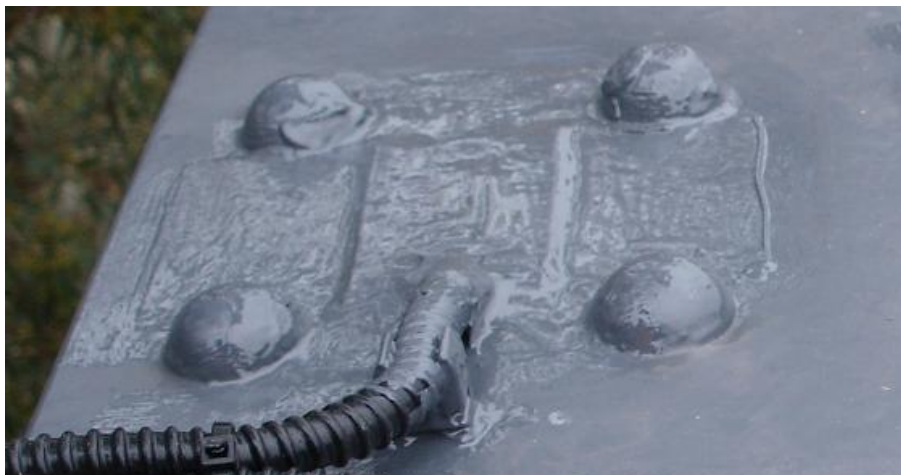
Fig. 2.12 - Aspecto final da aplicação de um transdutor.
