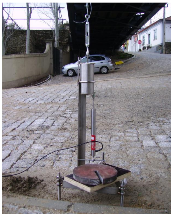
Fig. 4.50 - Ilustração do LVDT usado na segunda fase do ensaio de carga.
