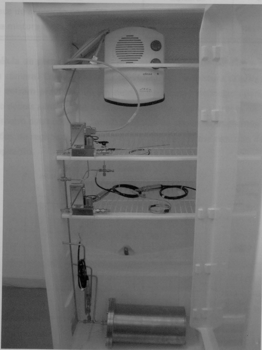
Figura 4.2. Unidade de determinação da permeabilidade de tintas ao CO 2 .
