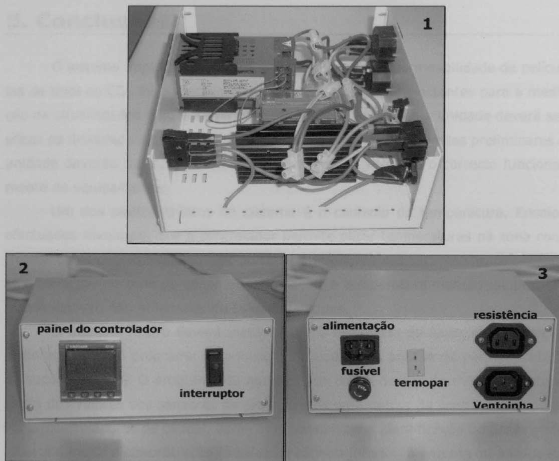
Figura 4.5. Controlador de temperatura da unidade de determinação da permeabilidade aos cloretos (1 – interior da caixa; 2 – painel frontal; 3 – painel traseiro).
