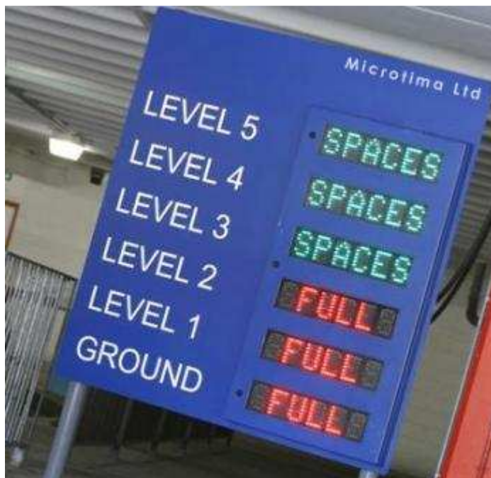
Figura 3-3 - Aplicação de um sistema PGI num parque de estacionamento. (Fonte: Microtima, Lda.)
