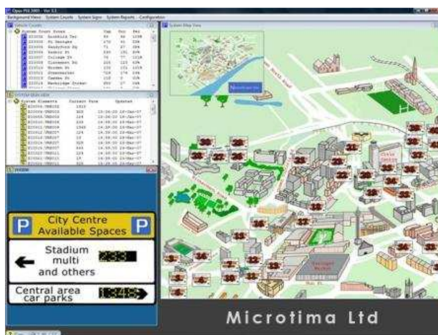
Figura 3-2 - Exemplo de software de controlo de um sistema PGI (Fonte: Microtima, Lda.)
