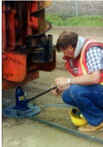
Fig. 4.2. – Esquema do ensaio do PLT usando uma máquina como massa de reacção
