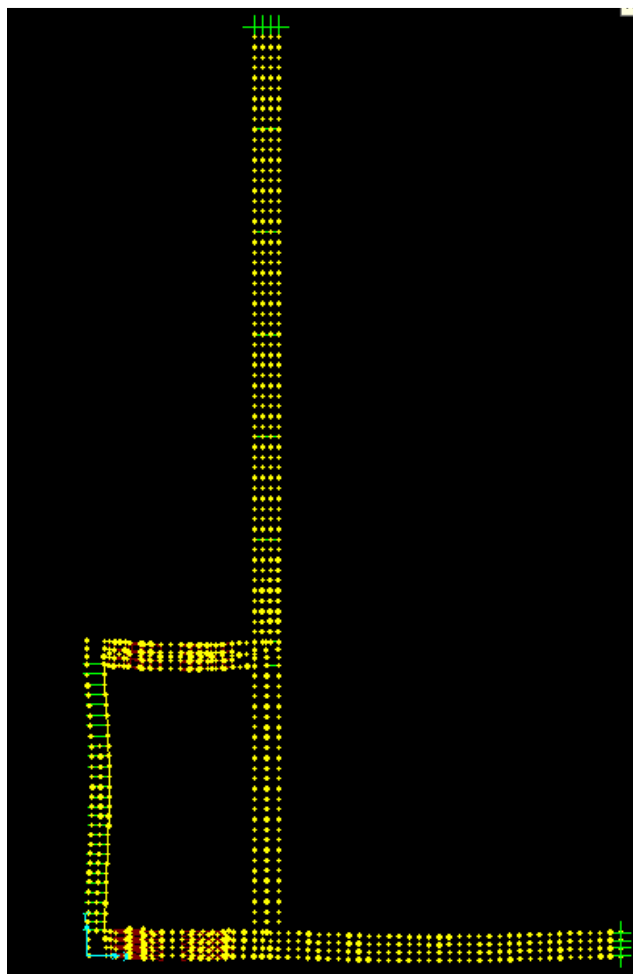
Fig. 6.20 – Corte horizontal ( z=5,15 ) da deformada tridimensional (Fig. 6.19) do quinto modo de vibração obtida através do sap2000 ( f_5 = 25,615 \text{ Hz} )
