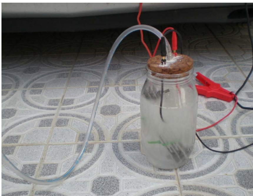
Figura 16 – Montagem de nova célula electrolítica, sem fita isoladora – 2ª Experiência
