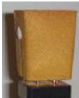
Figura 9 - Cadinho de análise térmica Electro-nite ® , usado pelo sistema ATAS ® da NovaCast AB. [13]
