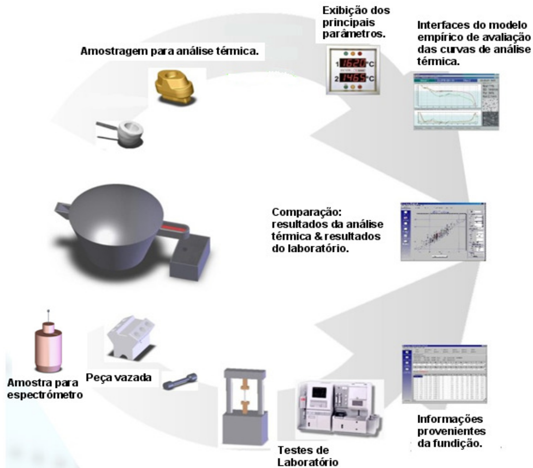
Figura 17 - Representação do fluxo de informação necessário para a preparação do modelo matemático de controlo empírico do processo de produção de ferro fundido compacto [8] .
