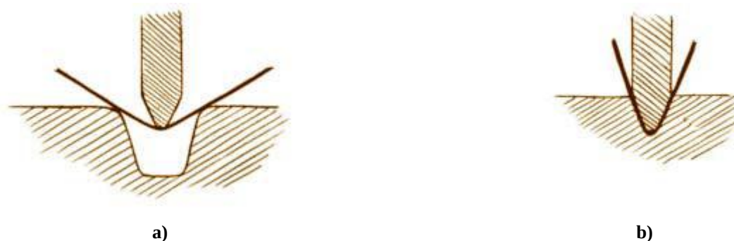
Figura 4-a) Quinagem livre ou quinagem ao ar; b) Quinagem forçada ou quinagem a fundo
