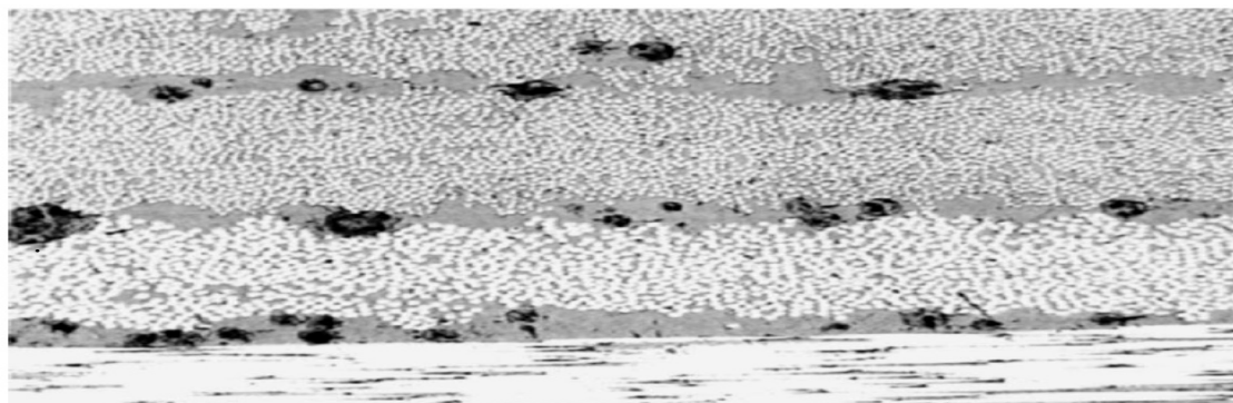
Fig.3.25 – Micrografia da secção de um material compósito laminado, reforçado interlaminarmente por partículas [3.30]
