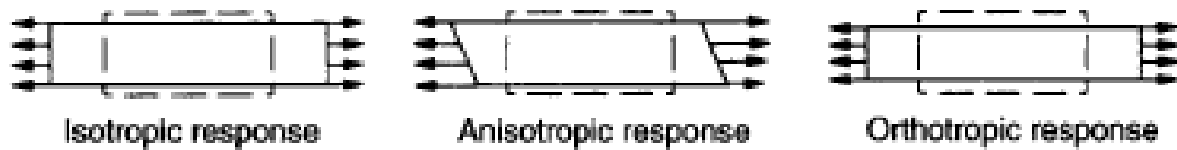
Fig.2.1 – Resposta típica para materiais isotrópicos, anisotrópicos ou ortotrópicos sujeitos a tensões axiais
