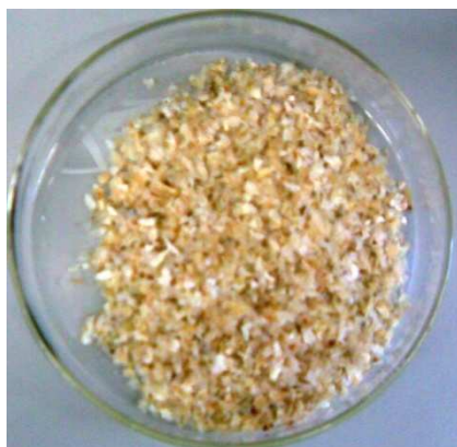
Figura 2 Cascas de Crustáceos, após a lavagem ácida
