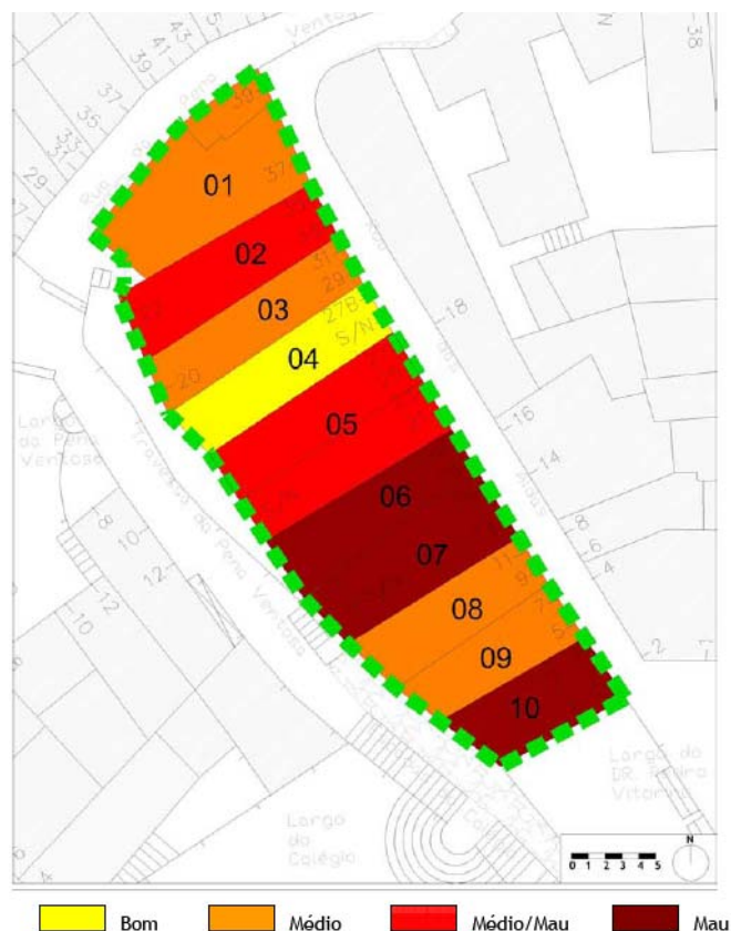
Fig. 3.9 – Estado de conservação do edificado
