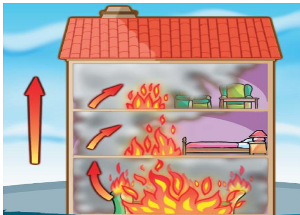
Fig. 2.4 – Transmissão de calor por convecção
